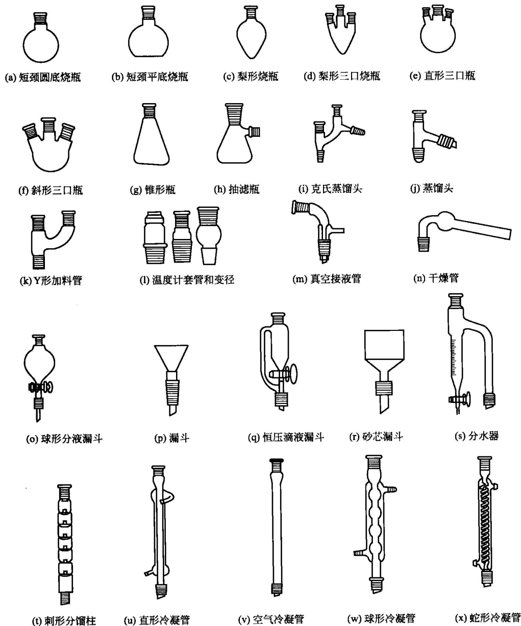
图 1-3 常用标准磨口玻璃仪器
