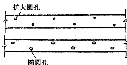
图 5-11 钢板钻孔螺栓锚固
