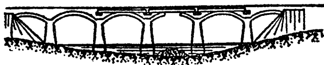
图 5-9 架设临时钢板梁的修复
