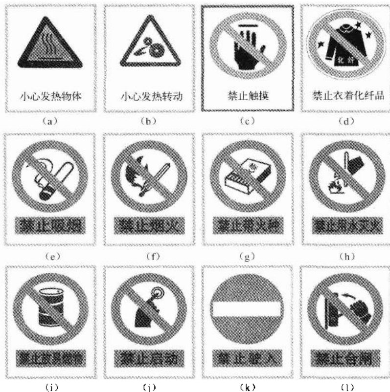
图 1-10 安全警示牌示例
