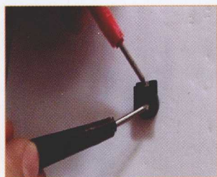
开路检测封闭式电感
