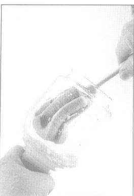
⑦用洗杯刷沾上清洁剂，刷洗上座。冲洗时小心不要敲破瓶口，玻璃管不要撞水槽或杯子等。
