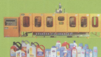
双层 (IML 型) 模内贴标吹瓶机
