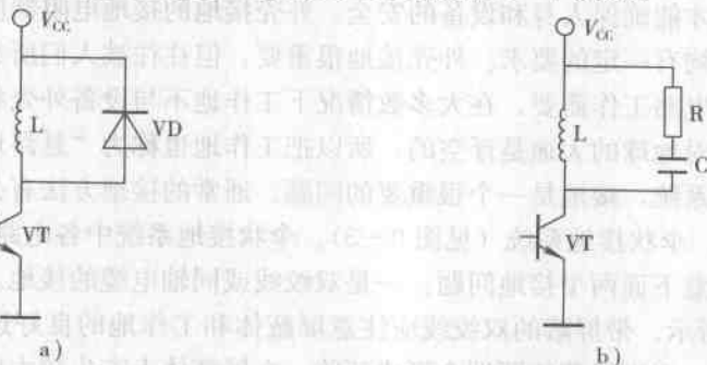
图 0—7 抑制反电动势干扰的典型电路
