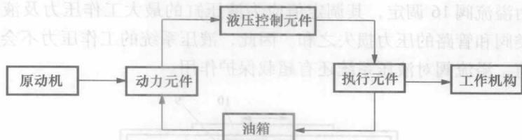
图 1-3 液压系统中各元件之间的关系图
