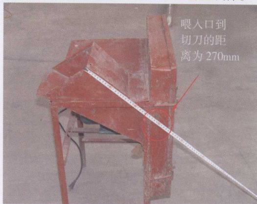
图 1-5 喂料口至切刀安全距离为 270mm
