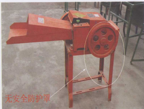
图 1-6 外露皮带轮无安全防护罩
