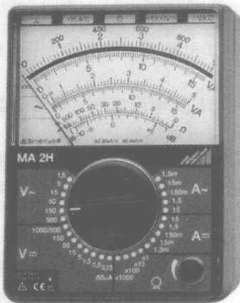
图 1-9 指针式万用表外形图
