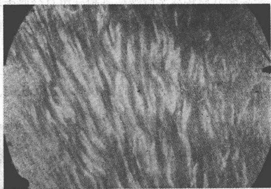
图 12. a) 经受腐蚀的聚癸二酸乙二酯部分球晶的电子显微照相(13500 倍); 6) 聚癸二酸乙二酯球晶的螺旋带状结构单元
