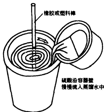
图 2-6 配制电解液的操作
