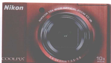
便携数码相机的镜头是固定到机身上的，不可以更换镜头，拍摄场合受到限制
