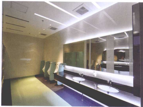
图 1-7 卫生间的地面选材要注意防水、防滑（工程案例）
