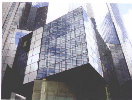
图1-23 大规格、轻质量、高强度的玻 璃幕墙
