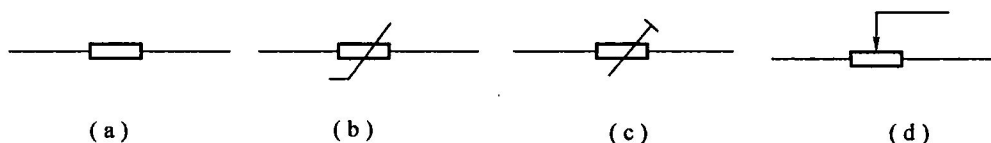
图1-8 电阻器的图形符号
