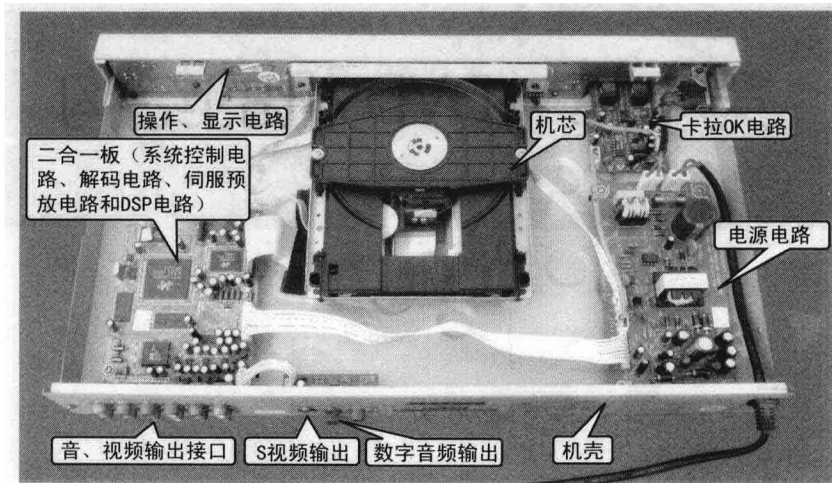
图 1-1 金正 N800A 型 DVD 机内部元器件安装图
