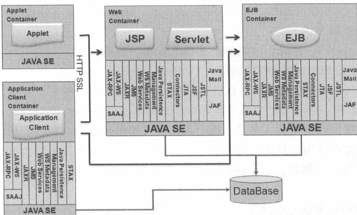
标准架构可以单独使用 JSP/Servlet 技术开发，也可以通过 EJB 完成分布式开发，但是此套开发架构的成本较高，所以在现在开发中开源架构也较为常用，如图所示。
