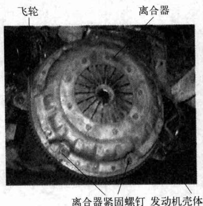
图 2-1 离合器的安装位置
