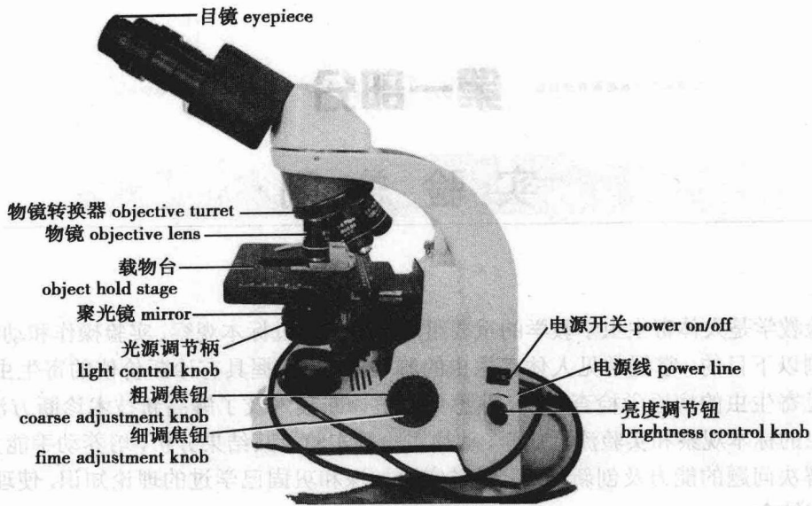
图 1-1 光学显微镜结构示意图 Fig. 1-1 Diagram of optical microscope
