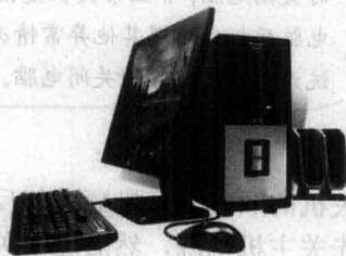
其中显示器和音箱是电脑的重要输出设备。显示器用于显示图形、文字等信息，音箱用于输出声音。鼠标和键盘则是最常见的输入设备。主机是安装有电脑全部重要内部配件的主机箱。
