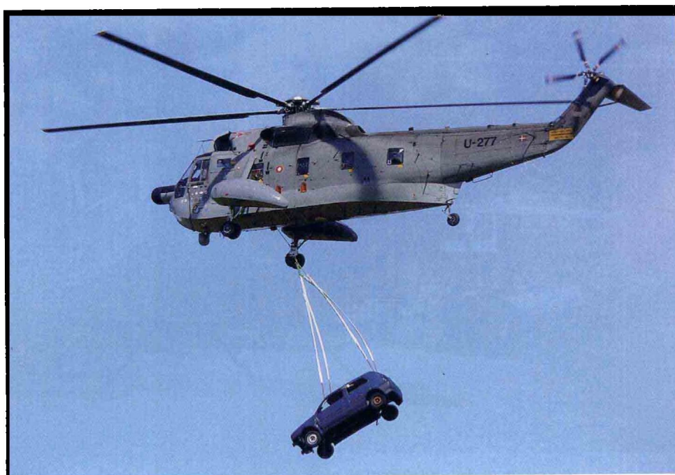
空中吊挂是直升机常用的作业方式
