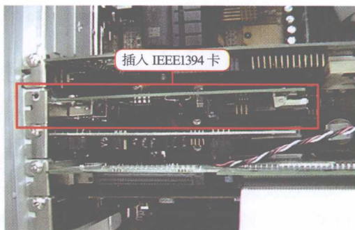
图 1-6 将 IEEE1394 卡插入 PCI 插槽
