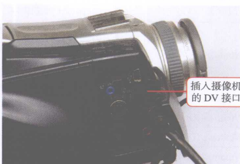
图 1-8 把 IEEE1394 线的另一端插入摄像机的 DV 接口
