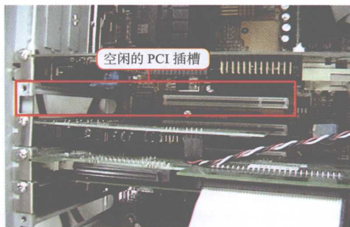
图 1-5 找到一个空闲的 PCI 插槽
