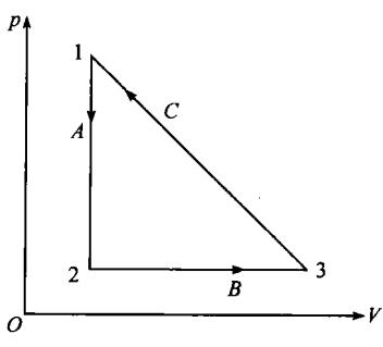
1-2 如左图,1 mol 单原子理想气体,由状态1经A、B、C三个可逆过程进行一个循环.已知  $p_1 = 4p^\ominus$ ,  $T_1 = 546 \text{ K}$ ;  $p_2 = 2p^\ominus$ ,  $V_2 = 11.2 \text{ dm}^3$ ;  $p_3 = 2p^\ominus$ ,  $T_3 = 546 \text{ K}$ .试求出各个过程的  $Q$ 、 $W$ 、 $\Delta H$ 、 $\Delta U$  及整个循环的  $Q$  和  $W$ .
