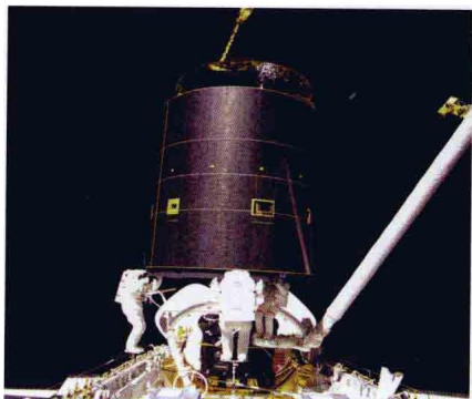
1992年奋进号航天飞机航天员对国际通信卫星 6 号进行在轨捕获和维修
