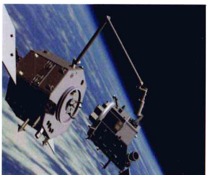
2007 年美国轨道快车计划，演示空间机器人自主目标捕获、模块更换和在轨加注等在轨服务
