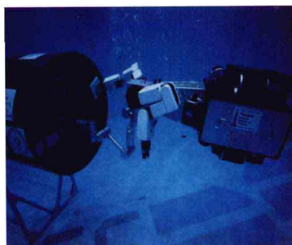
美国马里兰大学进行的自由飞行机器人“巡逻兵”零浮力飞行器RNBV的地面水浮模拟试验
