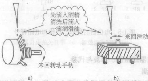
图 1-7 电位器转动时噪声大的简易修复
