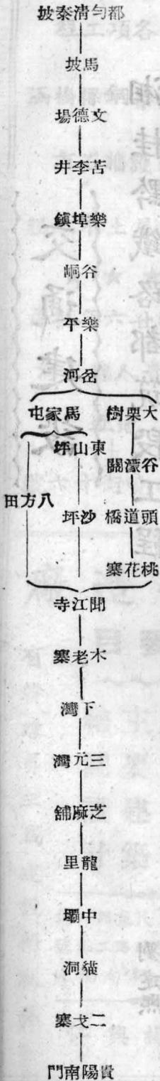
定測路線經過地點已如上表所示，就中岔河至開江寺一段，穿過雲霧山脈，前經桂鐵路乃採用經過東山坪分水嶺之線，本處施測之時，即會徵求該線之紀錄圖表，迄未獲得，地上樁樑，亦腐失殆盡，經於該處選測一條極順直之路線，若採用現行標準，則該線中有隧道一座，長至二千五百公尺，工程浩大，實所驚人，在黔桂時期所定此隧道之長度，據傳聞長約一千七百公尺，惟係採用何種標準，不得而知，當時以此項工程，甚為艱鉅，非短期內所能完成，曾另籌建築八方田便線，以應提前通車之需要，本處鑒於此段路線關係非輕，故於改測之初，即加審慎研究，經反覆履勘，發現在貴定附近一帶，穿過雲霧山脈之壩口，以谷濠關地勢為最低，勘測之初，曾與東山坪八方田二處詳加比較，用視距法測繪地形，以審度東西兩面河流距離及坡度情形，山谷寬窄彎曲之狀態，以期路線可以展開，隧道長度可以減為最短，茲將三
