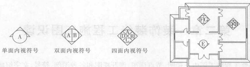
图 2.1.1 平面图上内视符号应用示例
