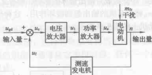
图 1—7 直流电动机转速闭环控制系统方块图
