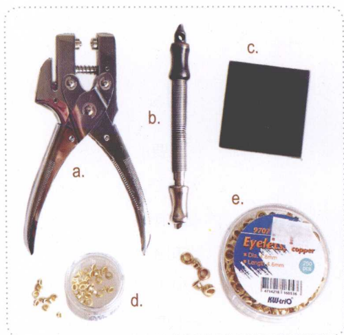
a. 大铜扣弹力压整器 c. 塑胶底皮 e. 大铜扣 b. 小铜扣弹力压整器 d. 小铜扣
