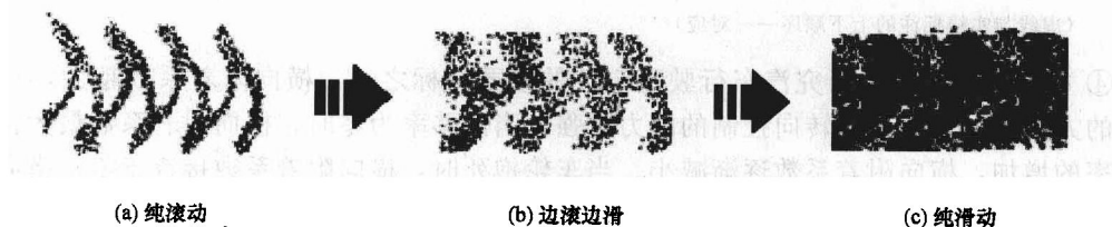
图 1-3 制动时车轮运动状态的变化
