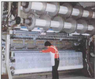
廈門化纖織造廠引進的提花經編機及配套的打孔複刺機等先進設備。
