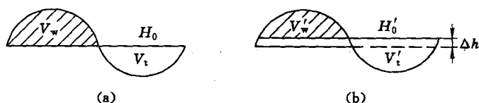
图 1-2 设计标高调整计算示意图
