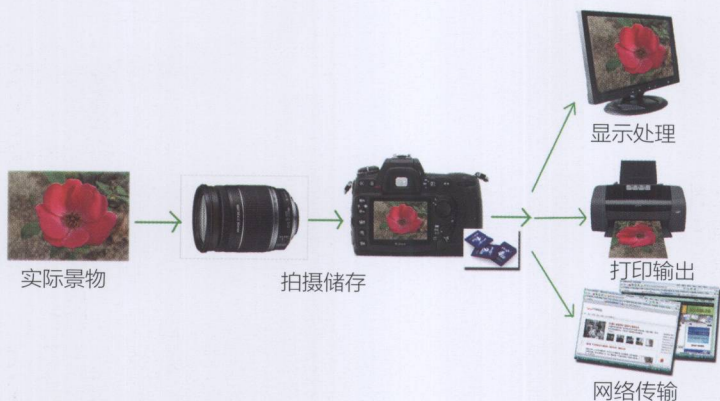
图1-1-2 数码相机工作示意图
