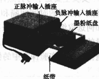
图 1-4 电火花打点计时器
