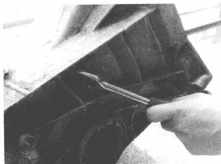
图 1-26 旋紧螺栓, 锁住分离轴承叉轴
