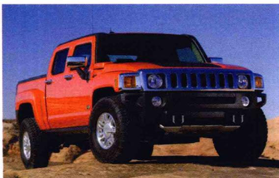
H3T融入四门皮卡的车型概念：1.5m长的货箱提供充裕而实用的载货空间，让车主可以随意装载诸如越野摩托车、露营帐篷等各种户外活动用品；同时搭配多变的货箱滑轨系统，以及简易操作的下掀尾门，大幅提升H3T在货物装载上的实用及便利性。此外原厂也在货箱下方附上全尺寸备胎，以应越野驾驶时的需要。
