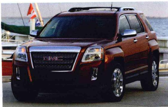
Terrarin 与 2010 款的雪佛兰 Equinox 共享 5 座车身结构，延续了 2858mm 轴距设计，车身短了 25mm，但宽了 25mm，采用独立悬架设计，可选择 17in、18in 或 19in 车轮。
