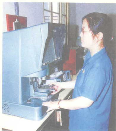
用投影仪检查电缆几何尺寸
