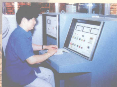
电缆耐电压试验
