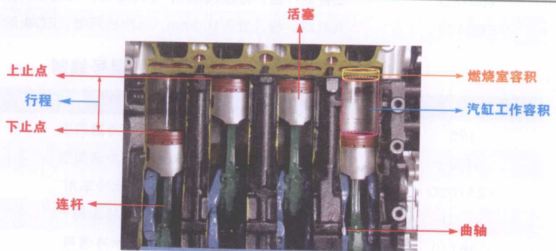
图1-12 发动机术语表示图（取自凌凯发动机示教台）
