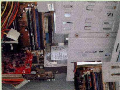
(1) 将硬盘安装到机箱的硬盘支架中。
