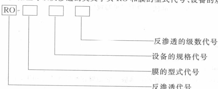
4.2.2 反渗透膜的型式代号(用汉语拼音字头表示):
