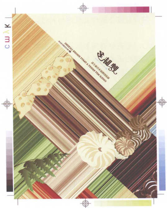
图 1-16 正确添加角线的方法
