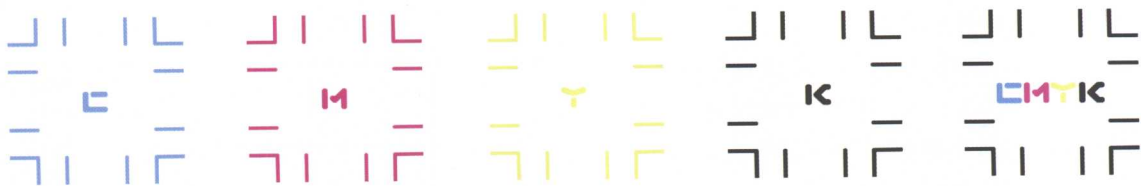
图 1-18 CMYK 四色角线示意图 (丘原制图)
