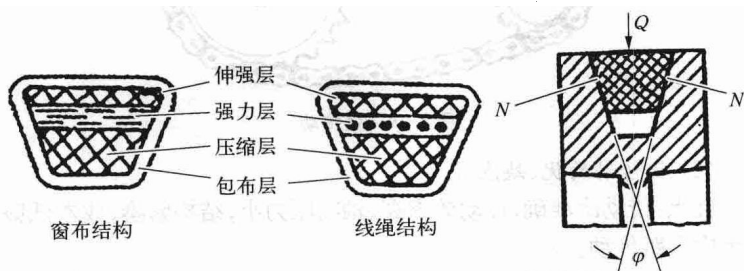
图 1-8(b) V 带结构
