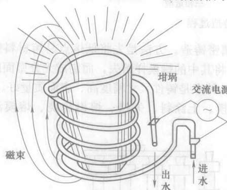
图 1-3 感应电炉熔炼原理
