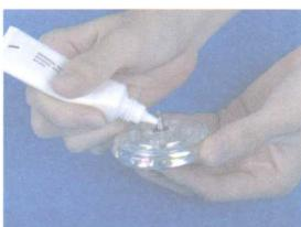
3. 在轴承托上方的轴心上加适量的润滑油。
