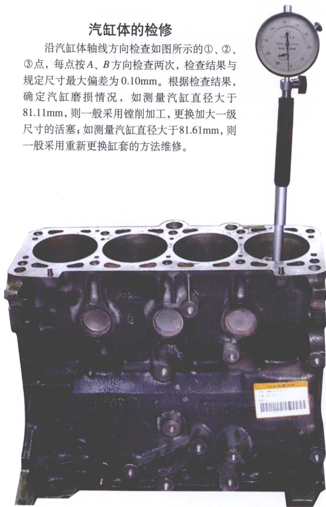
汽缸直径测量
