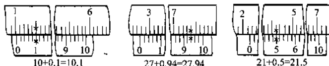
图 1—16 0.02 mm 游标卡尺的读数方法示例
