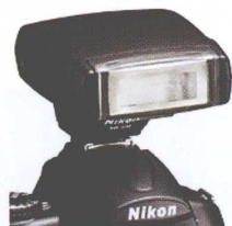
热靴： 用于插拉外置闪光灯，从而进行更多、更强大的闪光设置
