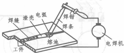
图 1.1 手工电弧焊的焊接过程
