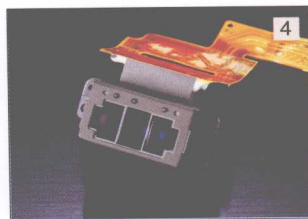
▲ 光学相位检测对焦传感器：分析由镜头聚焦、再由反光镜折射而来的光线对比度，当合焦时，会在一个位置上出现最高反差效应
