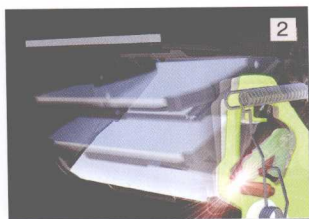
▲ 半透明反光镜箱：把大部分由镜头而来的光线反射到机顶的取景器，然后再把少量光线折射到底部的 AF 传感器上
