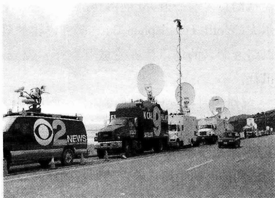
图 1-1 美国电视媒体直播现场的卫星直播车和微波直播车
